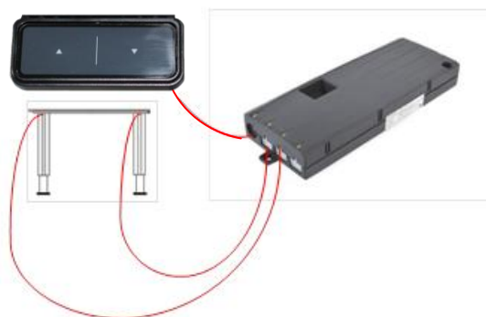
Abbildung 3: Anschluss des Auf/Ab Handschalters an die Motorsteuerung
