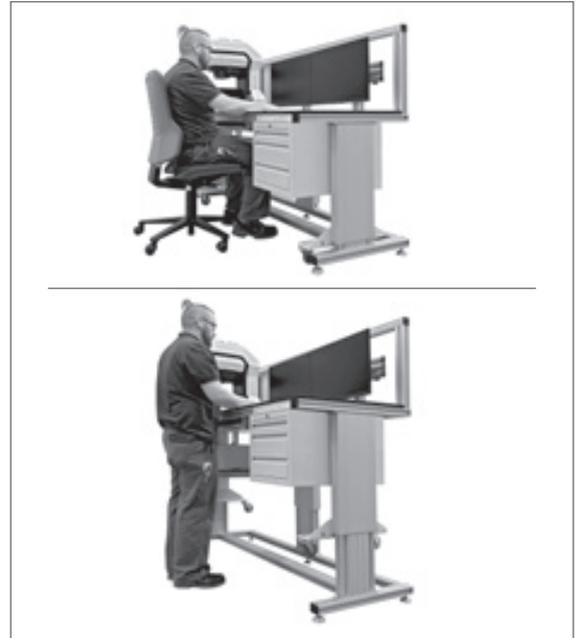
Prüfearbeitsplatz KEYENCE Grundarbeitsplatz mit Optionen 1-7 bestückt mit Messmaschine, Bildschirme, Drucker und PC<sup>1)</sup>
