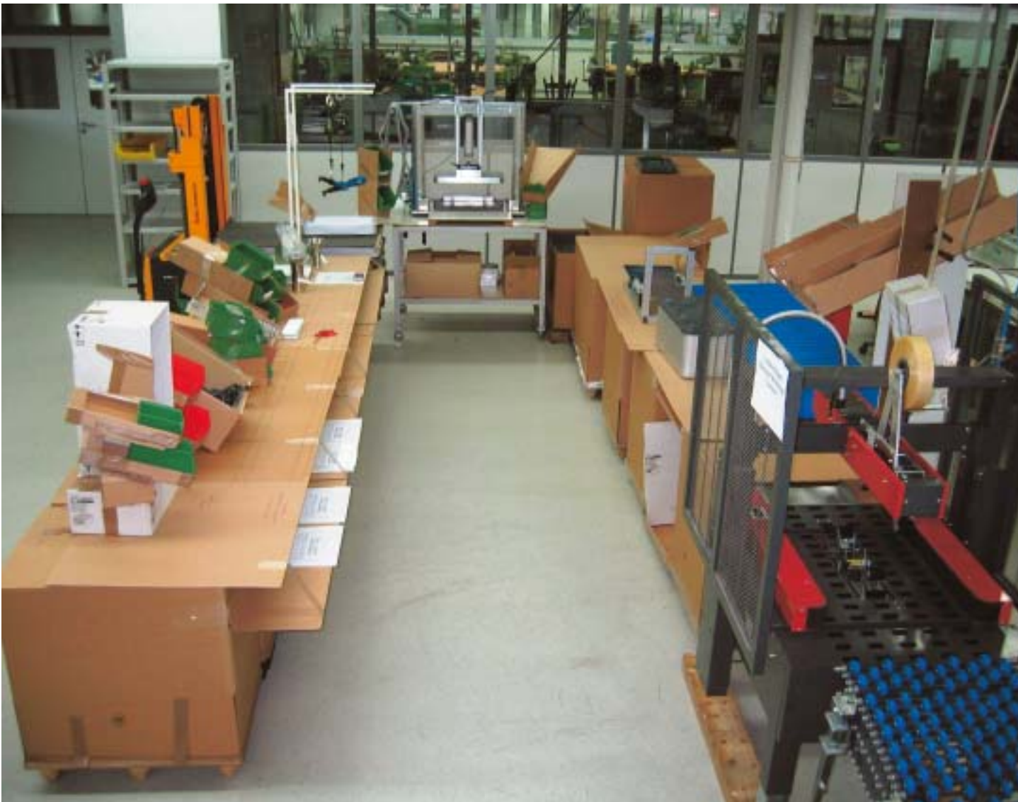
„Cardboard Engineering“ dient der Arbeitsplatzmodellierung und Ablaufsimulation und damit der realitätsgetreuen Kreation neuer Arbeitsplätze.
