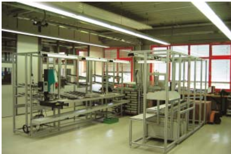
In der Umsetzung bieten die aus Aluminiumprofilen gefertigten Arbeitsplätze bei der Karl Leibinger Medizintechnik höhenverstellbare Arbeitsflächen und individuelle LED-Beleuchtung.
