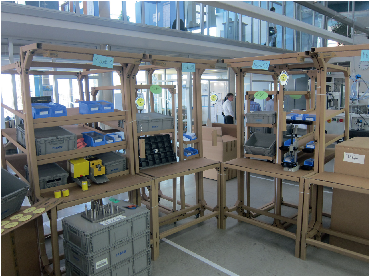
One-Piece-Flow Montagelinie mit Cardboard-Engineering
