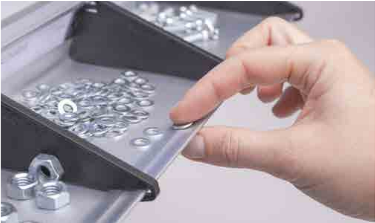
Kleinteilebereitstellung, Entnahme mit Vereinzelung über Abstreifgriff
