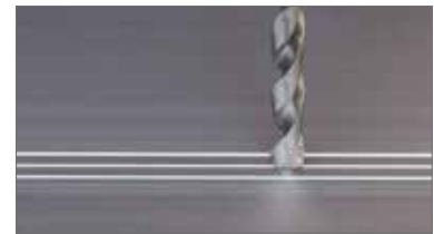
Bohrung Nr.1 einbringen
